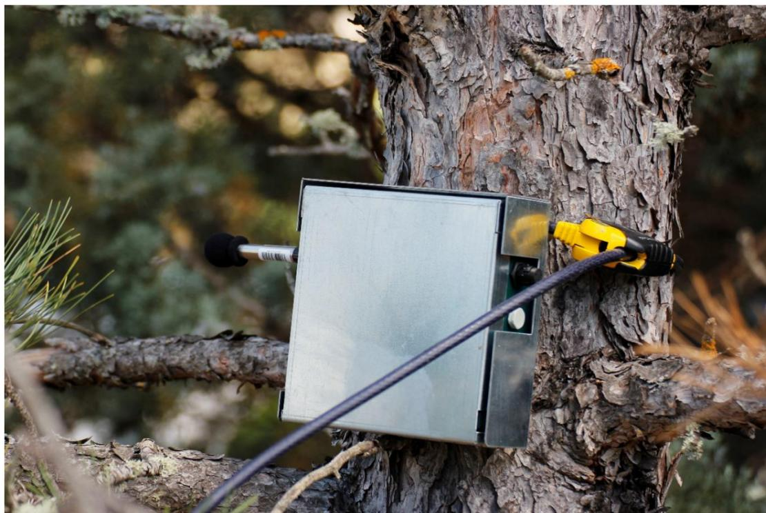
Figure 124 : Pose de SM2Bat+ pour les inventaires acoustiques au sol (Source : J. PELÉ)
